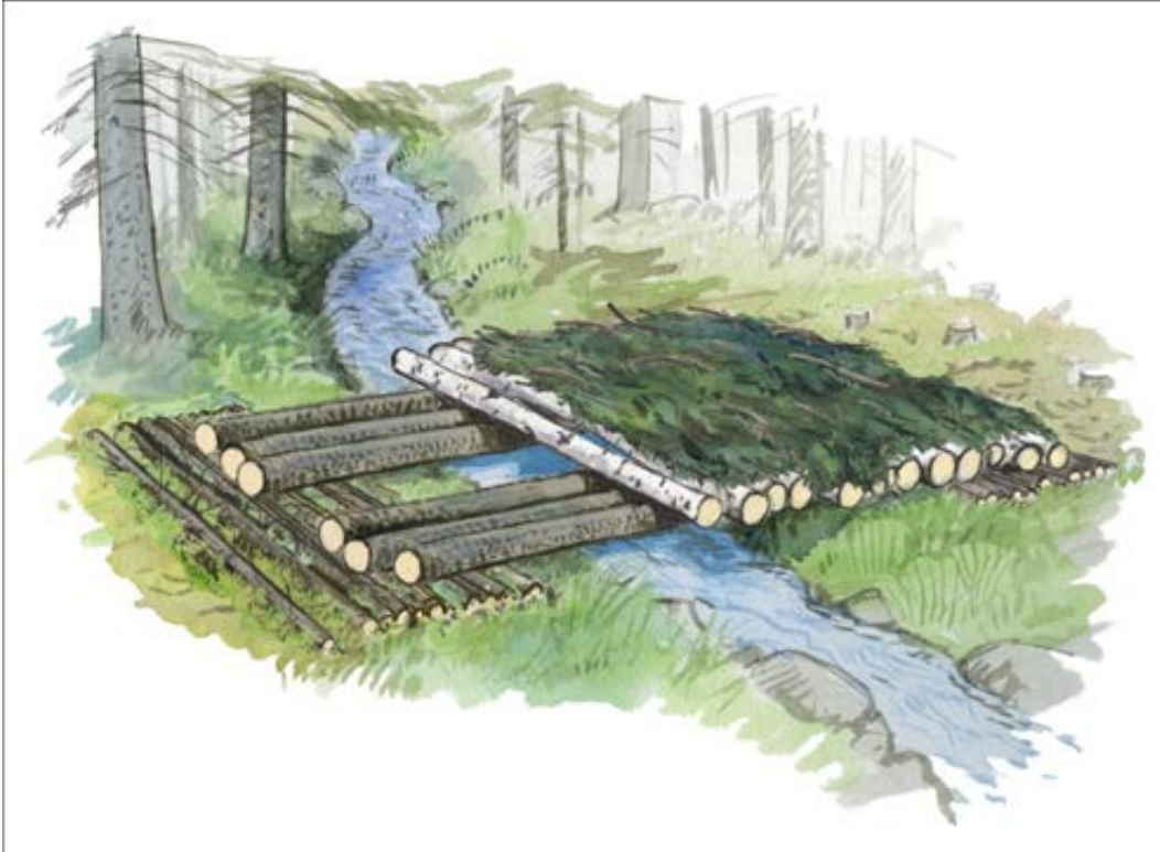
Bild 46. Exempel på hur en virkesbro kan konstrueras. Illustration: Martin Holmer.
