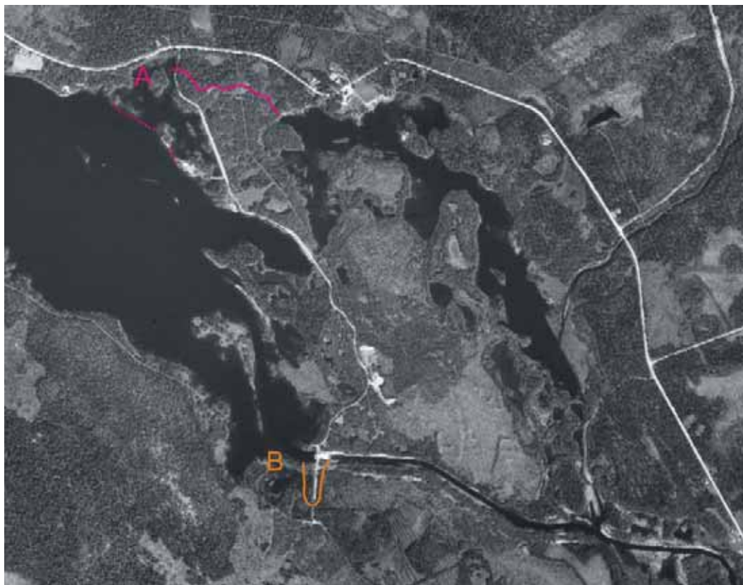
Figur 24. De två förslag till vandringsvägar genom Vojmsjödammen som tillsammans kan skapa både lek- och uppväxtområden (A) och en vandringsväg under isfri period (B). A utgår från att den naturliga bäckens väg utnyttjas till omlöp tillsammans med en refugdamm i Vojmsjön. B utgörs av omlöp från Vojmsjön och den lilla närmast kanalen. För att detta ska få önskad funktion krävs att mätpunkten för minimivattenföring flyttas till dammen i stället för Helitorp så att kanalen alltid för vatten.
