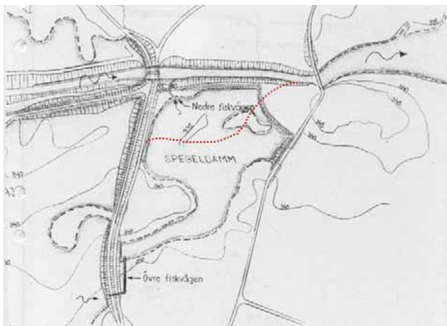
Figur 37. Förslag till fiskväg i Malgomajs regleringsdamm, av fiskeriingenjör Carl Arne Schmidt 1959-01-21.
