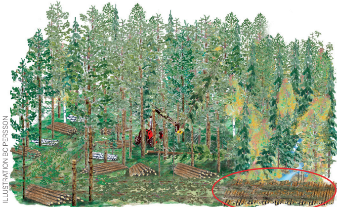
Basvägen är dragen över ett surdråg med hjälp av en kavelbro (rödmarkerad).
